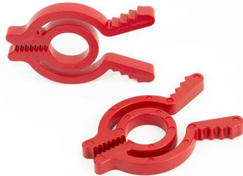
Abb. 2: Mit der Airmould Gasinnendrucktechnologie benötigt die Herstellung der Wäscheklammern aus Polypropylen im Vergleich zum Kompaktspritzguss 26,3 Prozent weniger Rohmaterial. Das Bauteilgewicht sinkt im gleichen Maß.
