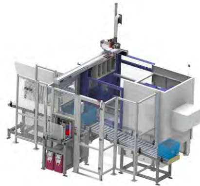
Komplette Automationszelle mit Kistenzuführung und SGM von WITTMANN.
