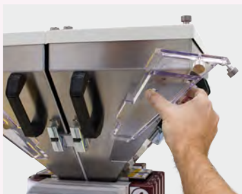
„Clip-on corner window“ (Ecksichtfenster) Einzigartige, herausnehmbare „clip-on corner windows“ (Ecksichtfenster) bieten einen guten Blick auf das Material im Trichter und vereinfachen durch leichte Zugänglichkeit die Reinigung.
