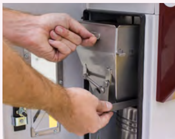
Herausnehmbarer Wiegebehälter Der Wiegebehälter sitzt auf zwei Führungen. Der Materialauslass-Winkel (60°) sorgt für komplette Zellen-Entleerung nach jeder Verwiegung. Der selbstschließende Auslass verhindert ein Ablassen des Materials bei Druckluftverlust.
