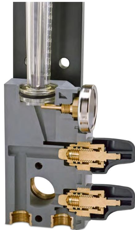
Das speziell für die Feinjustierung der Durchflussmenge entwickelte Ventil wurde von der **Flowcon plus** Baureihe übernommen. Es ermöglicht eine exakte Regelung der Durchflussmenge in Schritten von 1/10 Liter.
