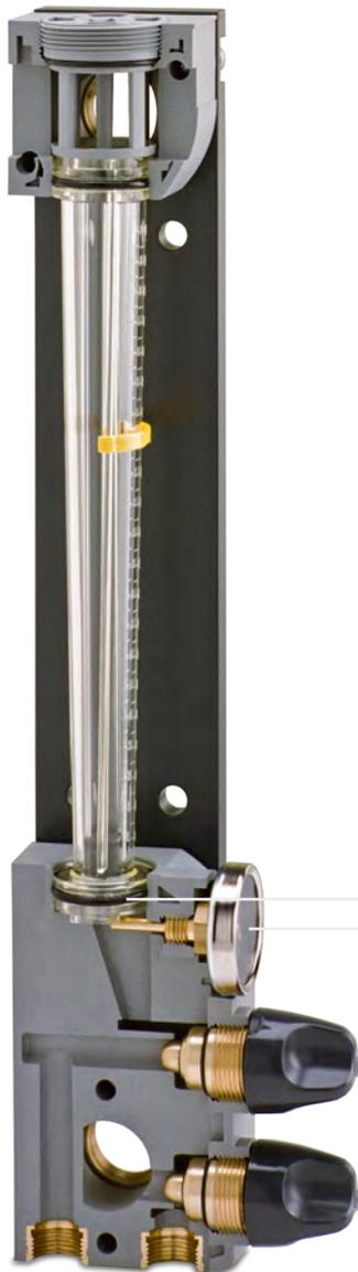
Die bewährte Rohrreinigung ohne Rohrentnahme durch das obere Gehäuse wurde auch für die Serien 110 und 310 übernommen. Ein O-Ringtausch ist durch Anheben des Rohrs aus der Halterung und anschließendes Durchziehen durch das Gehäuse leicht durchzuführen.
