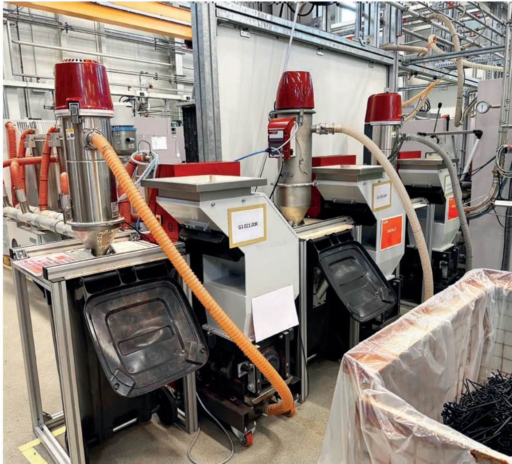
Das neue Recycling Center in der Spritzgießproduktion: Vier Mühlen vom Typ WITTMANN S-Max 2 wurden fürs Inhouse-Recycling beschafft.
