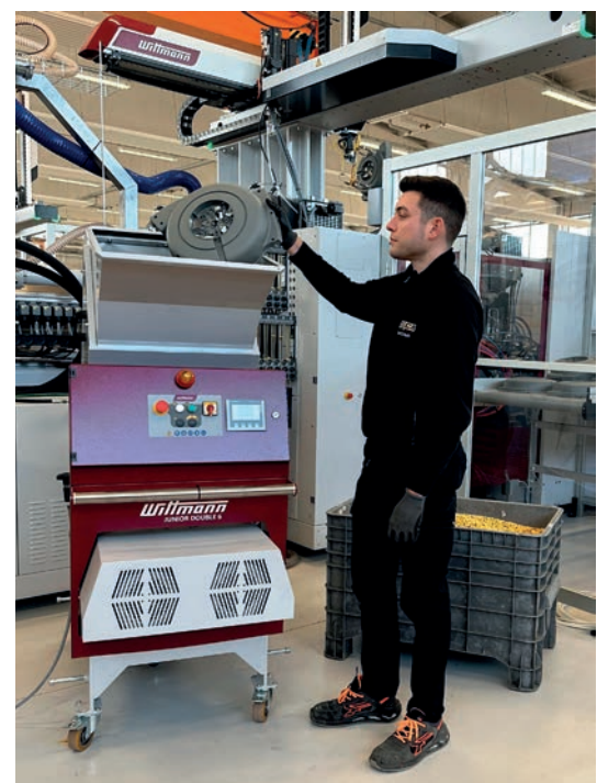
Angüsse und Ausschussteile werden direkt an der Maschine vermahlen.
