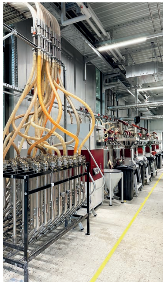
Das Mahlgut wird mit Gravimax Dosiergeräten grammgenau in die Materialversorgung eingespeist.
