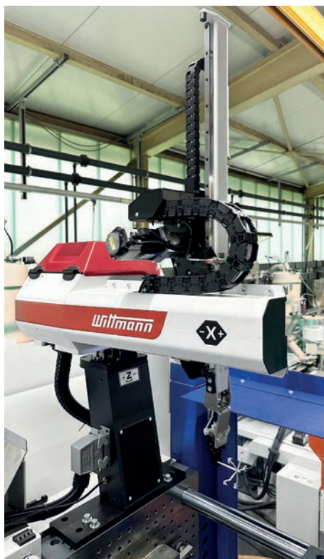
Ausgestattet mit einer R9-Steuerung ist der neue WX90 vollständig in die Produktionszelle integriert.
