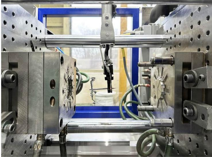
**Abb. 3:** Dank seiner Servoantriebe zeichnet sich der WX90 durch sehr präzise, fließende Bewegungen aus.
