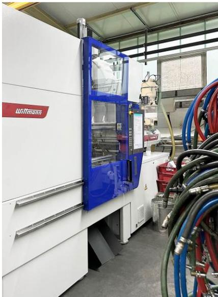
**Abb. 4:** Die neuen SmartPower Spritzgießmaschinen steigern die Energieeffizienz der Spritzgießproduktion.
