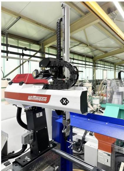
**Abb. 2:** Die neuen Angussentnahmegeräte mit Servo-Drehachse vom Typ WX90 besitzen eine R9-Steuerung und sind damit vollständig in die Produktionszelle integriert.
