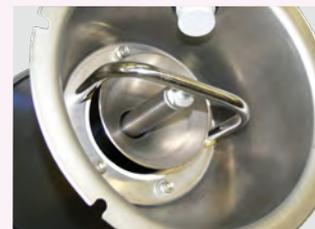
Die **pneumatisch betätigte Auslaufglocke** garantiert hohe Funktionssicherheit durch eine vollständige Abdichtung während des Förderzyklus. Staubdichte Konstruktion garantiert auch materialtrichterseitig einen staubfreien Betrieb.
