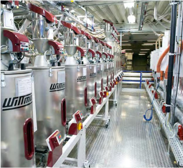
Der modulare Aufbau der WITTMANN M8 Hardware- und Softwarekomponenten und die beliebige Konfigurierbarkeit ermöglichen die flexible Realisierung zahlreicher Spezialanforderungen, wie beispielsweise die gleichmäßige Auslastung und automatische Umschaltung zwischen Förderpumpen, die überwachte Zuordnung von Materialquellen zu den Verbrauchern.
