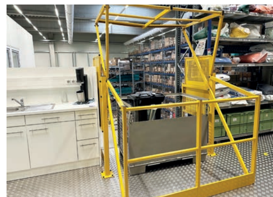
El contenedor de material lleno de granulado se eleva al piso superior hacia el sistema central de manejo de materiales, utilizando un montacargas con sofisticados dispositivos de seguridad.
