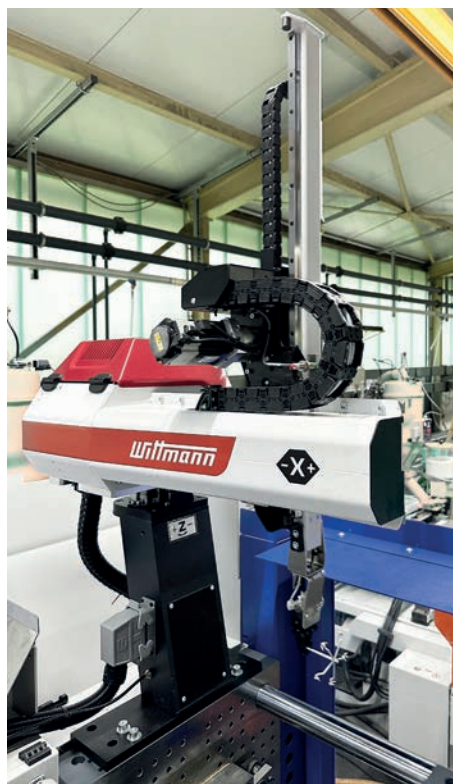
Los sistemas de extracción de colada WX90 están equipados con un sistema de control R9, integrados en la celda de producción.
