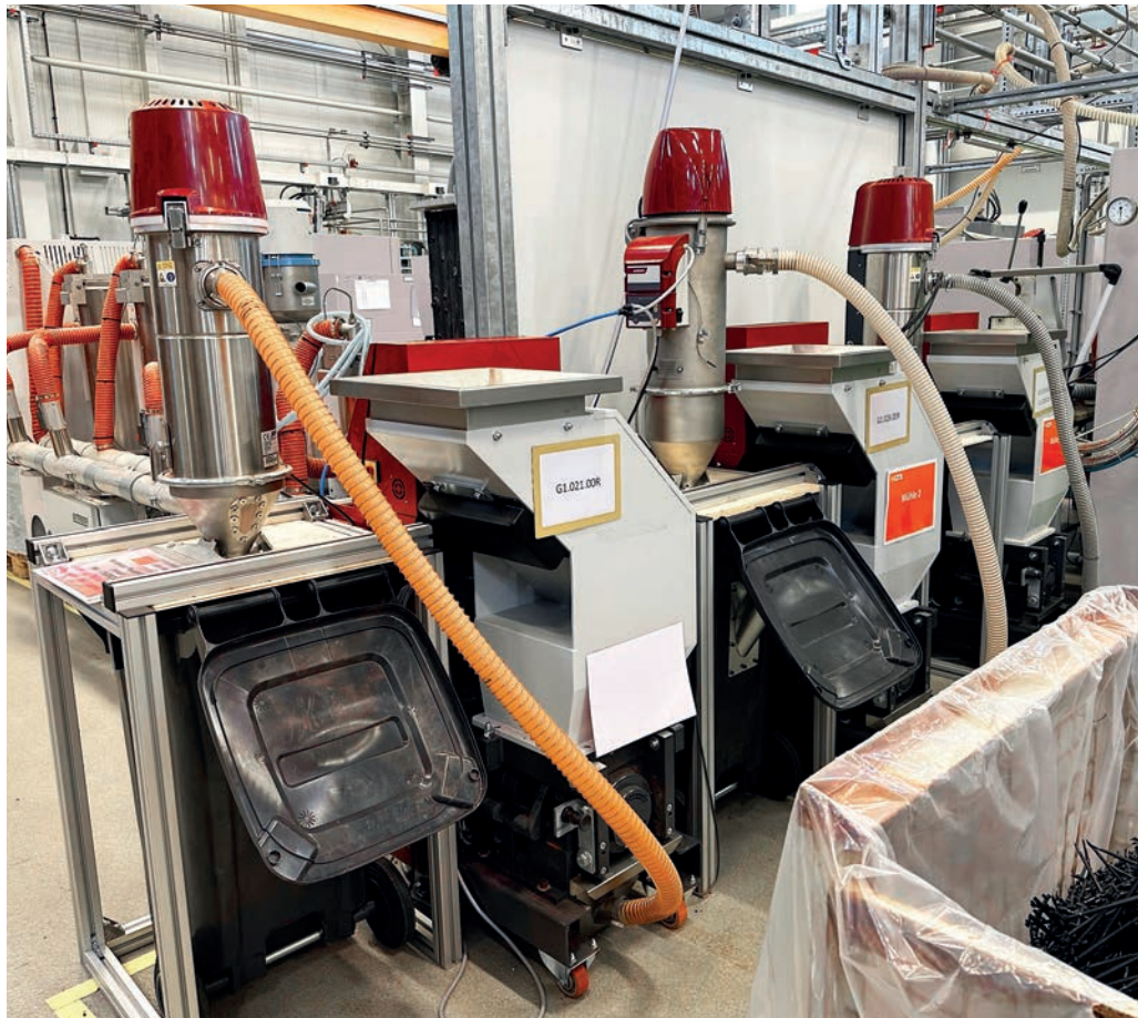
En el nuevo centro de reciclaje en la planta de producción de moldeo por inyección se han adquirido cuatro molinos S-Max 2 de WITTMANN para el reciclaje interno.
