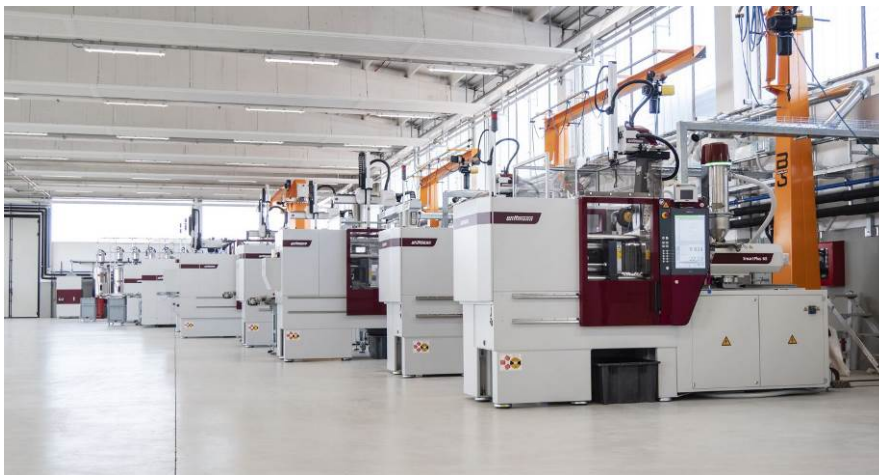
Abb. 1a+b: Mit acht automatisierten und vernetzten Spritzgießmaschinen von WITTMANN erreicht ZECA viel Flexibilität – sowohl für die eigenen Produkte als auch für den Geschäftsbereich Lohnspritzgießen. (Bilder: ZECA)
