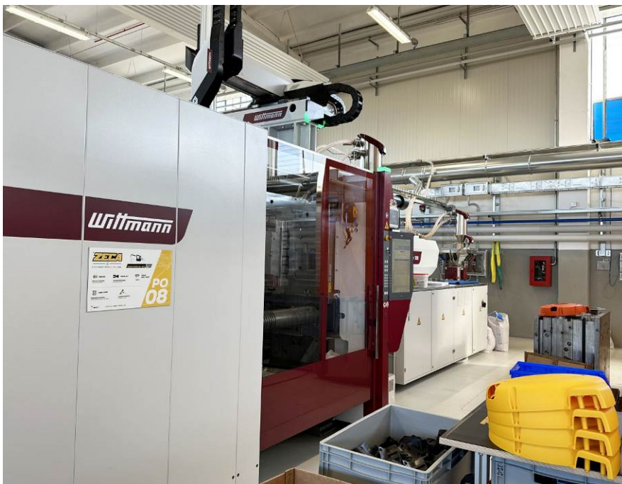
Abb. 5: Mit Schließkräften von 60 bis 700 Tonnen deckt der Maschinenpark ein breites Anwendungsspektrum ab. (Bild: WITTMANN)
