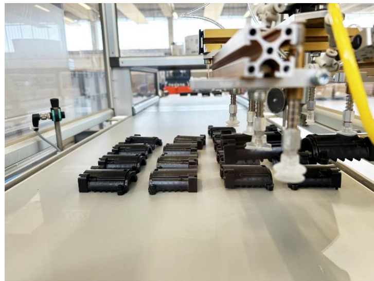
Abb. 9a+b: Die Griffstücke aus PC-ABS werden in zwei Hälften in einem 2+2-Fachwerkzeug produziert. (Bild: WITTMANN)
