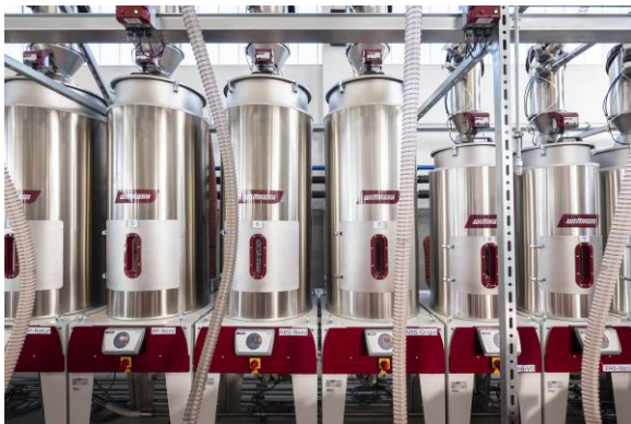
Abb. 6a+b+c: Die Zentralanlage zum Trocknen und Fördern der Granulate versorgt alle acht Spritzgießmaschinen mit einem breiten Materialspektrum. (Bild: ZECA)
