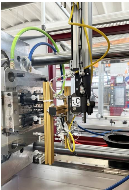
Abb. 9a+b: Die Griffstücke aus PC-ABS werden in zwei Hälften in einem 2+2-Fachwerkzeug produziert. (Bild: WITTMANN)
