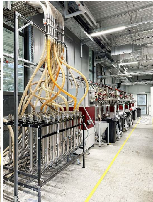
Abb. 4a+b: Das Mahlgut wird mit gravimetrischen Dosiergeräten vom Typ Gravimax grammgenau in die Materialversorgung eingespeist.
