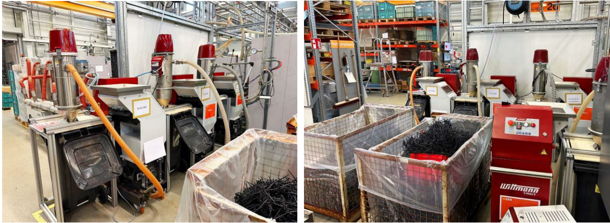
Abb. 1a+b: Das neue Recycling Center in der Spritzgießproduktion: Vier Mühlen vom Typ WITTMANN S-Max 2 wurden fürs Inhouse-Recycling beschafft.
