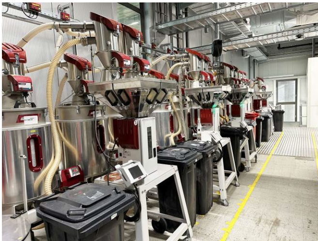
Abb. 4a+b: Das Mahlgut wird mit gravimetrischen Dosiergeräten vom Typ Gravimax grammgenau in die Materialversorgung eingespeist.
