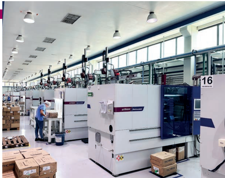
Insgesamt 44 Spritzgießmaschinen sind im Einsatz. Den Löwenanteil machen servohydraulische SmartPower Maschinen aus.
