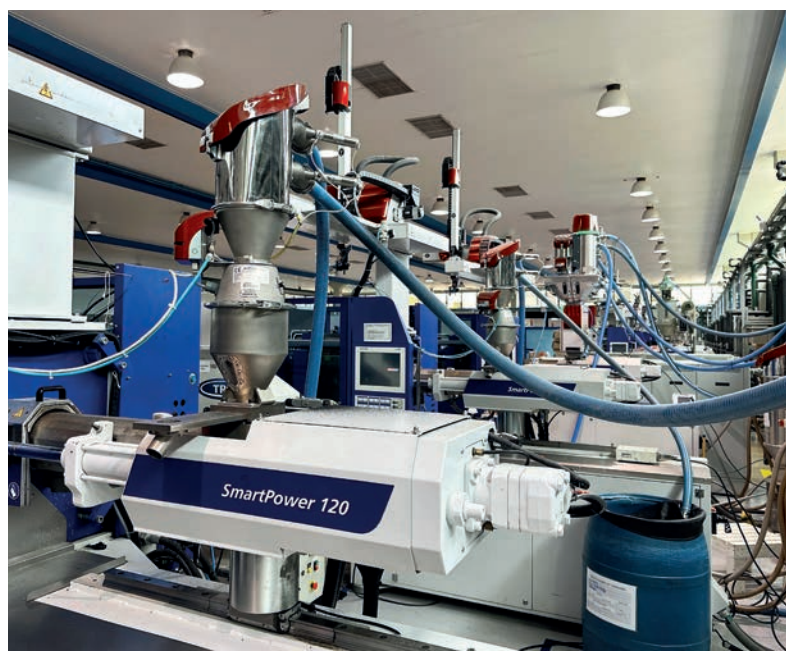
Alles aus einer Hand: Die Granulatversorgung erfolgt durchgehend über WITTMANN Peripherie.
