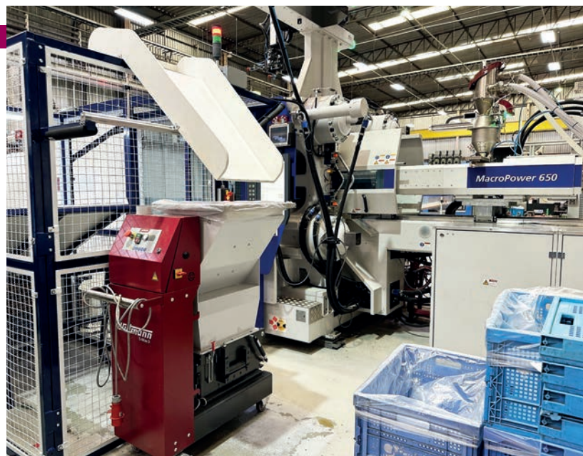
Angüsse werden zum Teil direkt an der Maschine vermahlen und wieder neu verarbeitet.
