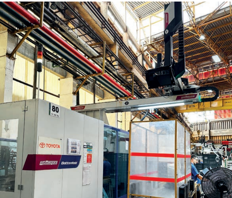
Die Handschuhfächer bestehen aus zwei Spritzgießbauteilen – Box und Deckel –, die auf einer MacroPower 650 produziert werden.
