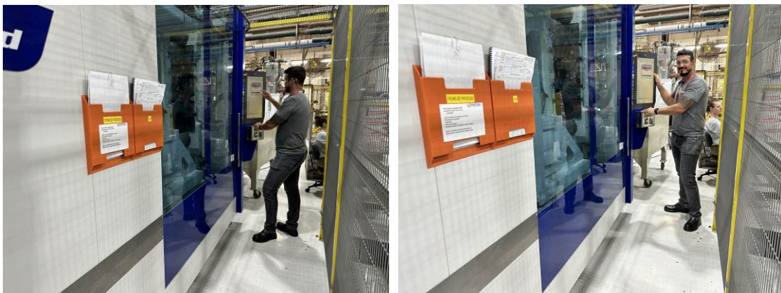
Abb. 4a+b: Einfach zu bedienen: Der Spritzgießprozess lässt sich inklusive Automatisierung zentral über das Maschinendisplay steuern.
