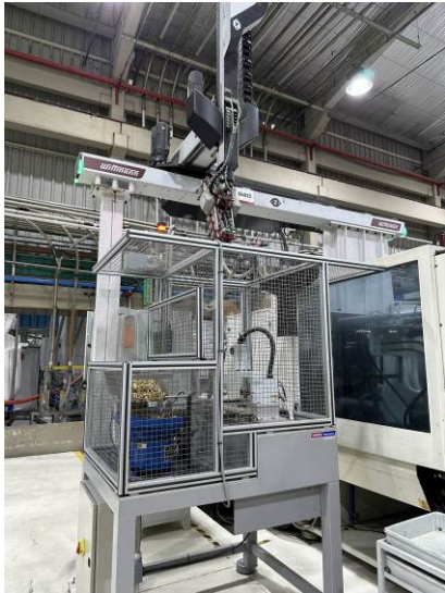
Abb. 9: Die Automatisierungszelle zum Vereinzeln und Zuführung der Metallgewinde wurde von WITTMANN BATTENFELD do Brasil als Sonderlösung für Krona konstruiert und gebaut.
