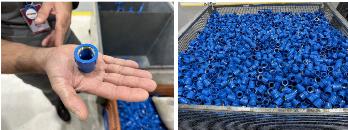
Abb. 7a+b: Im Bereich Armaturen werden vielfach Metalleinleger umspritzt.
