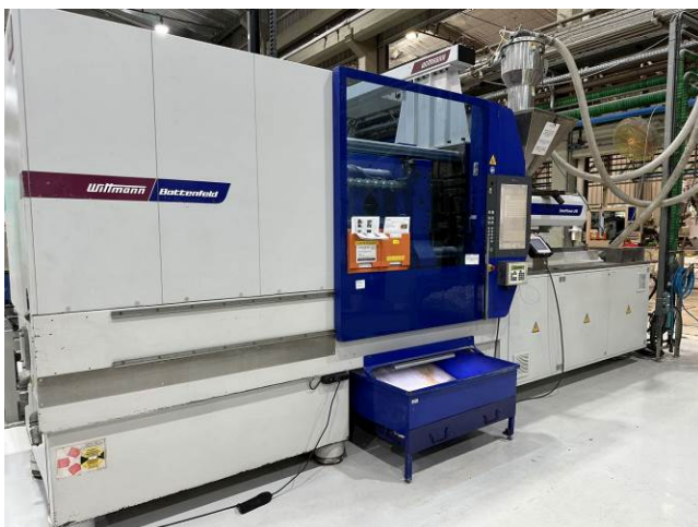
Abb. 8: Für die Produktion der Armaturenstücke mit Metallgewinde entwickelte das WITTMANN Team einen neuen vollständig automatisierten Produktionsprozess rund um eine SmartPower Spritzgießmaschine.
