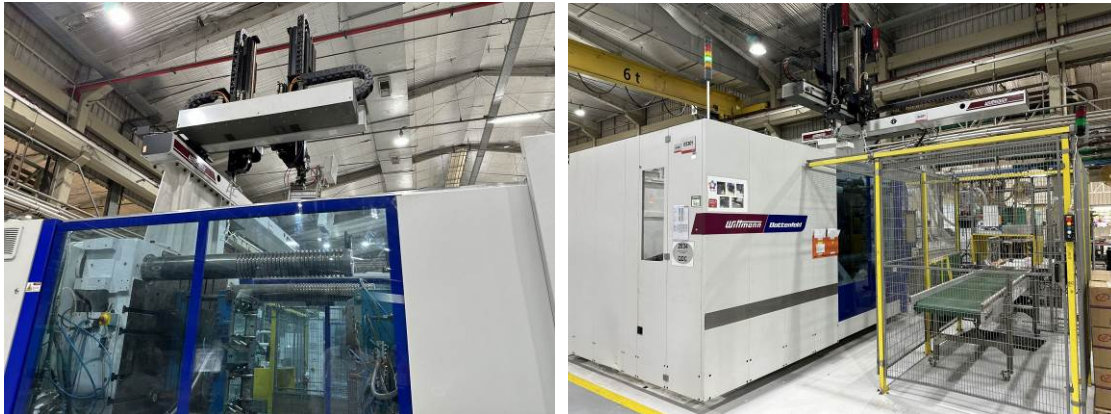
Abb. 6a+b: Nicht von der Stange: Für Krona entwickelt WITTMANN BATTENFELD do Brasil anwendungsspezifische Automatisierungslösungen. Zum Beispiel einen Linearroboter mit zwei Armen.
