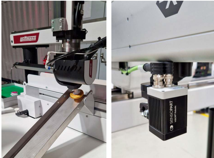
Abb. 3a+b: Kameraintegration leicht gemacht: WITTMANN hat hierfür eigene Schnittstellen entwickelt. (Bilder: WITTMANN)
